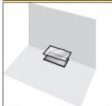
1. Подготовьте основание для установки цоколя. Для этого на увлажнённый пол уложите цементную подушку, выполните гидроизоляцию, нанесите цементный раствор.
