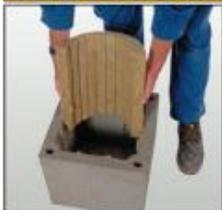
21. Изоляционные плиты согните, как показано на рисунке. Место соединения двух изоляционных элементов должно располагаться
