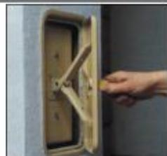
56. Удалить транспортный фиксатор с рычага дверцы и прижать внутреннюю часть дверцы путем закрытия наружной дверцы.
