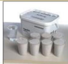
12. В случае применения сухой смеси для заделки швов разместите её точно в соответствии с прилагаемой инструкцией (7 частей смеси и 1 часть воды). Последующие операции - см. рис. 13 и 14. Работы по приготовлению смеси выполнять при температуре окружающего воздуха 20°C. Готовая масса должна быть использована в течение 1-1,5 часов. Ни в коем случае не допускается добавление воды в готовую смесь!
